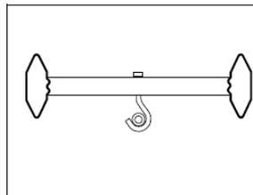
Crochet 8 monté à travers un échelon perforé.
