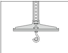
Crochet 8 monté sous un support 3 pour poser un câble.
