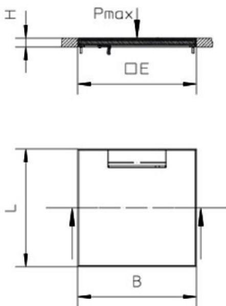
La cassette, le couvercle rempli avec sortie latérale et le levier autofermant sont fabriqués en acier inoxydable.
